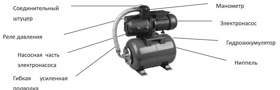
Поверхностный центробежный электронасос состоит из однофазного асинхронного двигателя и насосной части.
